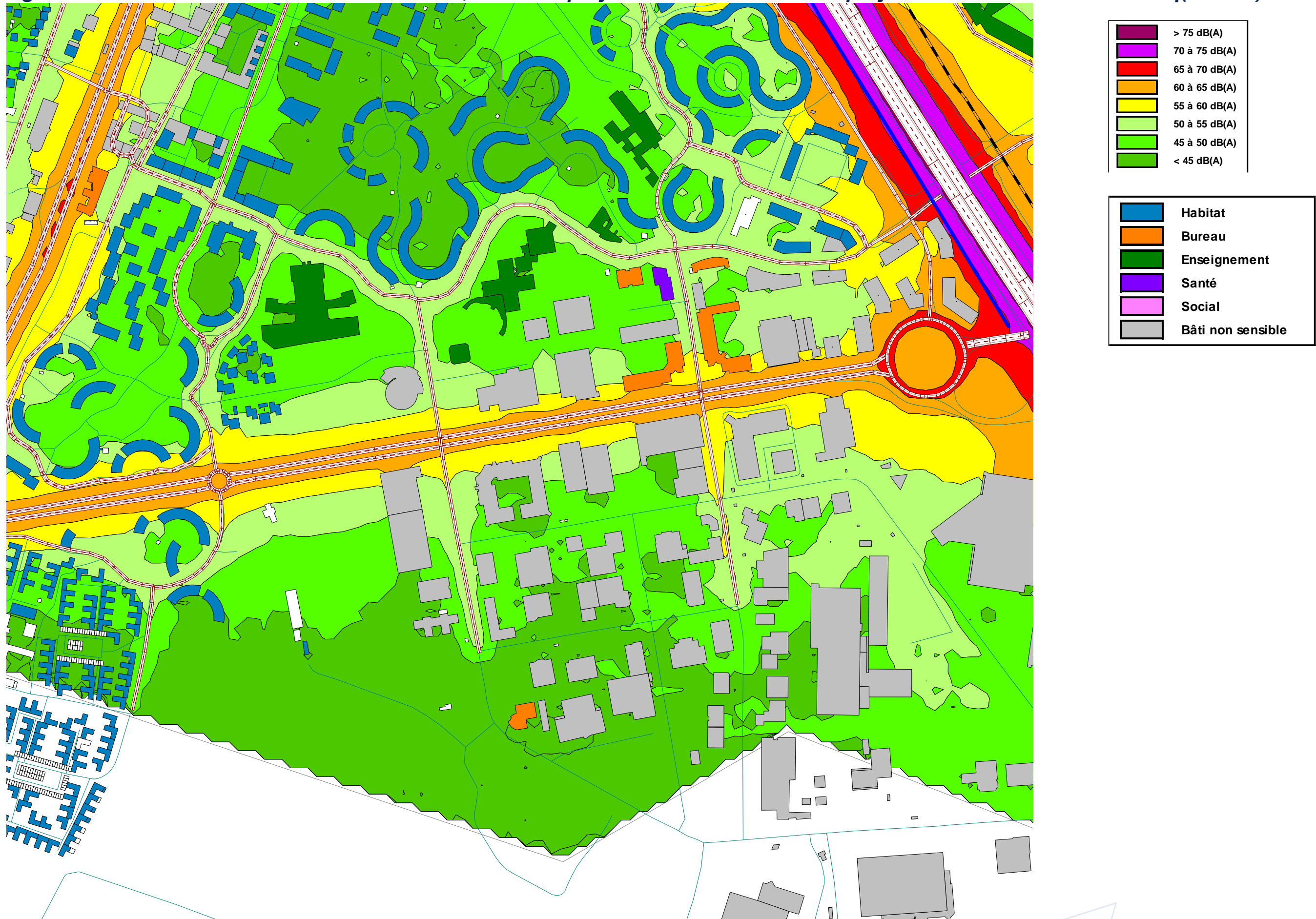
Figure 31. Carte de bruit à 4 mètres de hauteur, situation projet à l'horizon 2035 sans projets connexes indicateur LAeq(22h-6h) – Secteur 3
