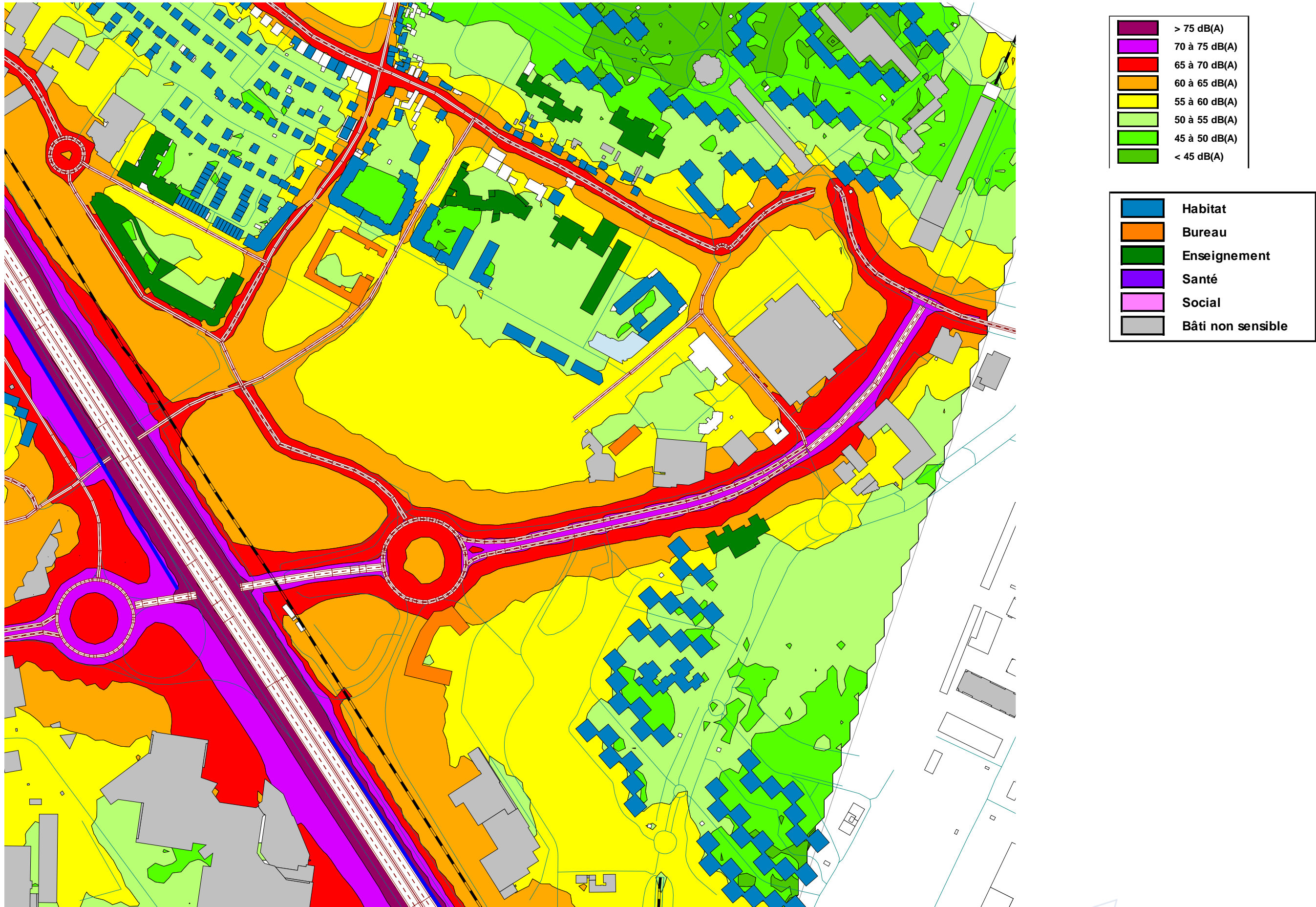
Figure 20. Carte de bruit à 4 mètres de hauteur, situation projet à l'horizon 2025 avec projets connexes indicateur LAeq(6h-22h) – Secteur 2
