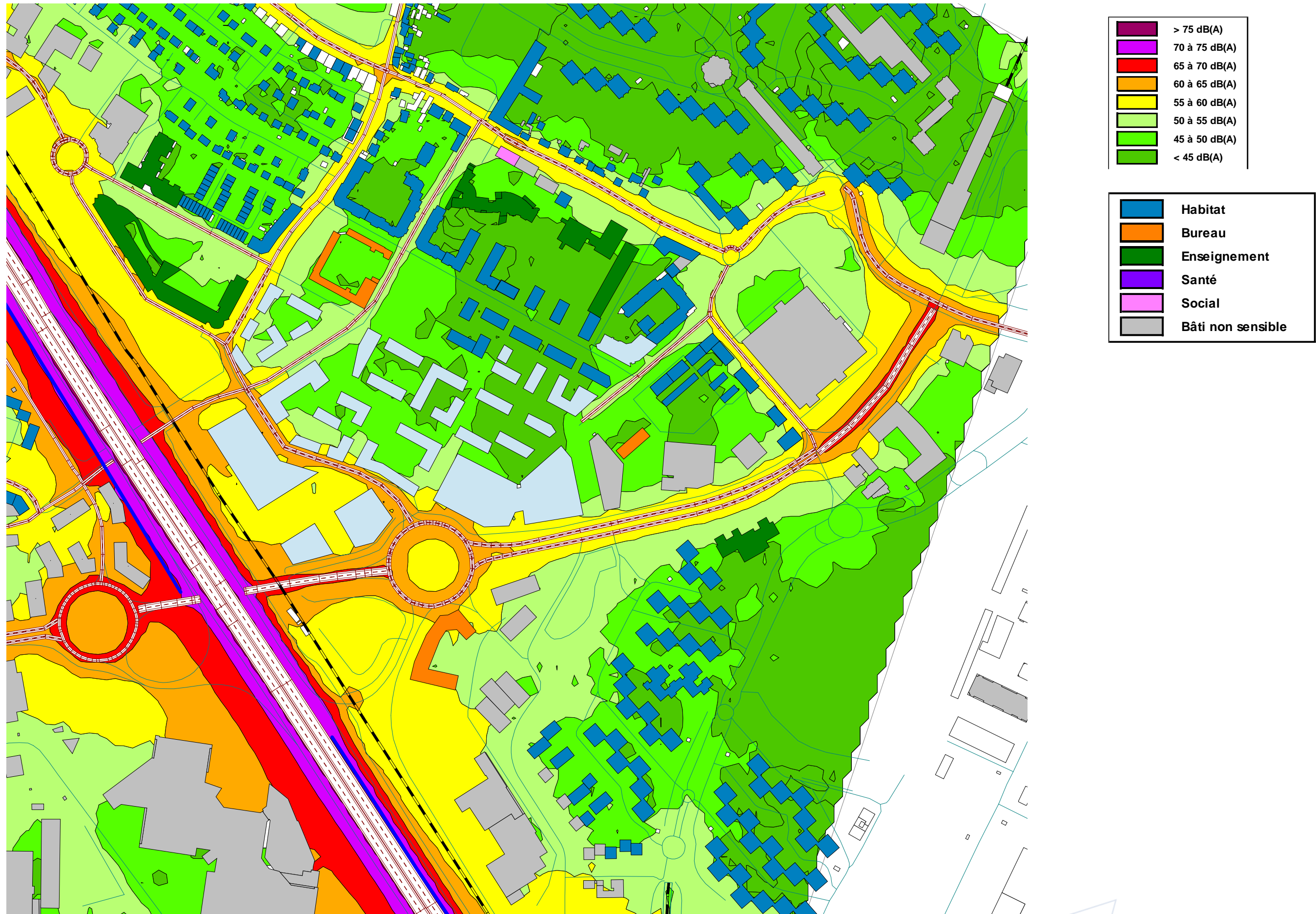
Figure 30. Carte de bruit à 4 mètres de hauteur, situation projet à l'horizon 2035 sans projets connexes indicateur LAeq(22h-6h) – Secteur 2
